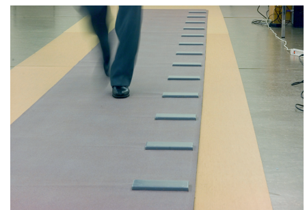
Abb. 3: Elektronischer Teppich zur Ganganalyse (GAITrite®). Erfasst wird die Gangvariabilität zur Bestimmung des individuellen Sturzrisikos (Photo Basel Mobility Center).
